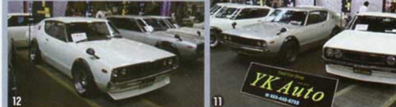
11 ローレルSGLは、L28型エンジン公認で、ヘッドチューンを施し、キャブはソレックス44PHH。前後とも車高調を装着。12 フルレストアしたGT-XのR仕様。全面白ガラスを採用し、エンジンはL28型公認。13 4ドアのGT-XがベースのR仕様。赤いヘッドカバーのエンジンはL28型公認で、キャブはウエーバーを装着。14 ジャパンGT-EXベースのR仕様。エンジンはL28型改3仕様を搭載。
