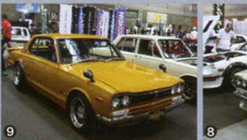
72年式GT-R仕様だが、よく見るとショートノーズの1800がベース車だと分かる。エンジンはG18型で、ソレックスキャブなどでチューンナップ。72年式4ドアGT-Xをベースに、L20型改2.4Lエンジンを搭載。王道ともいえる71年式のハコスカGT-R仕様。72年式のGT-R仕様は、珍しいサファリアブラウンの1台。搭載するエンジンは、L28型改3仕様。70年式2432は、エンジンをはじめ、前後オーバーフェンダーなどモディファイ!
